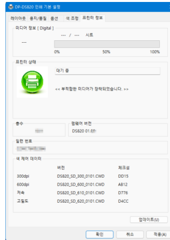
그림 2.2.6.2 부적합 미디어 장착 표시
